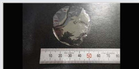
製作した薄膜型 固体飛跡検出器
