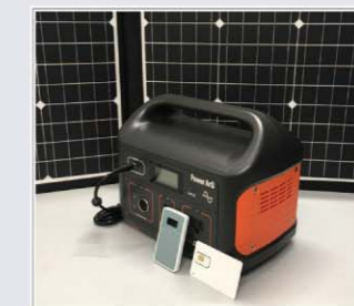
ポータブル電源と モバイルルータ
