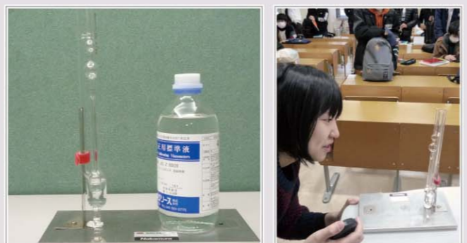
ウペローデ粘度計と校正用標準液 ▲ 粘度測定を行う学生 ▲
