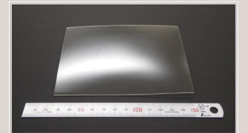
製作した大型のプラスチック検出器 ▲
