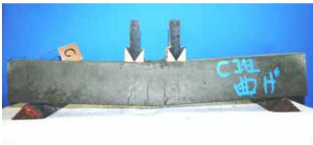
設計上ひび割れの発生を許容し、ひび割れ幅で制御している。
