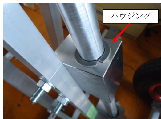
写真10：自動車のハンドル軸受圧入部
