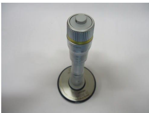
写真1：ホールテストとリングゲージ
