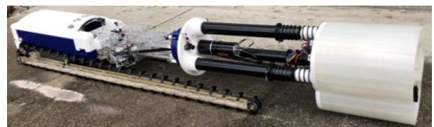
図-18 完成したデブリ取り出しロボット
