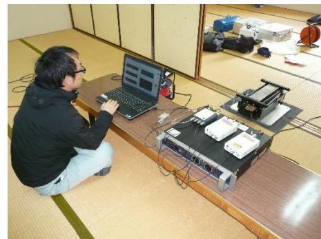
写真3 微動計測および振動実験風景
