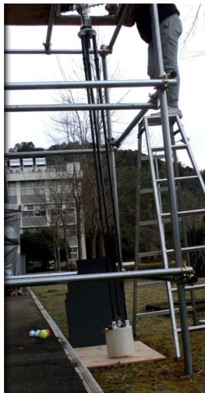
図-21 デブリに見立てたボールの回収試験
