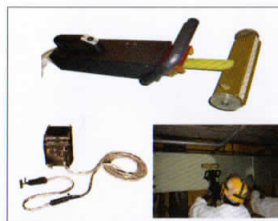
IH式被膜剥離
