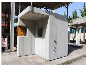
写真-5 完成したコンクリート試験体 (右: 配筋の実物大解答シート)
