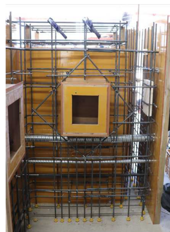
写真-4 ③配筋探査 試験壁 (開口部, シース管, PC 鋼棒)
