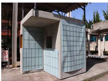
写真-5 完成したコンクリート試験体 (右: 配筋の実物大解答シート)
