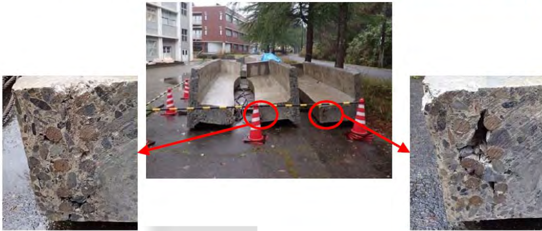
図3. 3 実物劣化教材: RC桁
