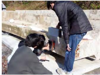
写真 2.5.6 鉄筋探査実習
