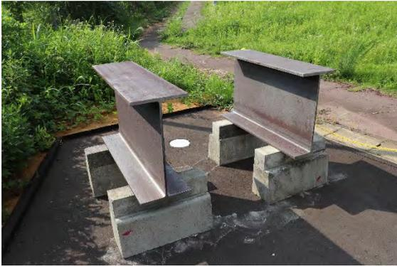
写真 2.2.3 耐候性鋼桁サンプル
