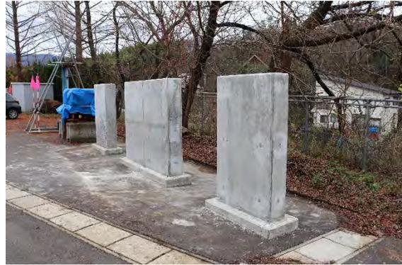
写真 2.2.4 コンクリート初期欠陥供試体
