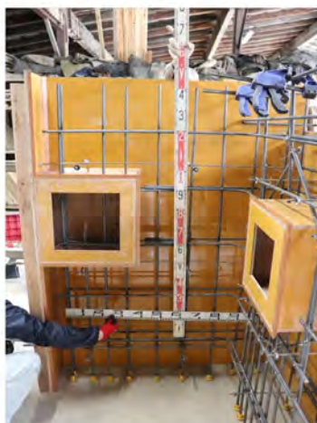
写真-3 ②橋脚モデル (左: S55 道示, 右: H8 道示)
