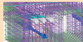
▶BIM/CIMによる干渉照査
