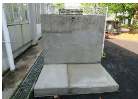
(D) 初期欠陥教材（豆板、砂筋、空隙、 コールドジョイント等）
