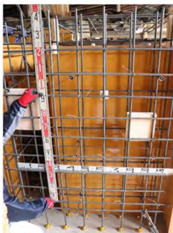
写真-3 ②橋脚モデル (左: S55 道示, 右: H8 道示)
