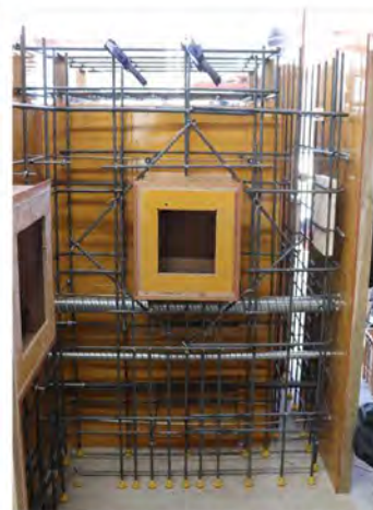
写真-4 ③配筋探索 試験壁 (開口部, シース管, PC 鋼棒)
