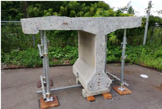
写真 3.2.2 塩害を受けたポストテンション方式 T 桁
