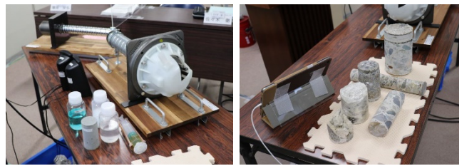
写真3 実物教材(PC定着部, コンクリートコア)
