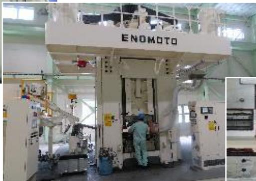
最先端のサーボプレスにより安定した鍛造加工を実現！
