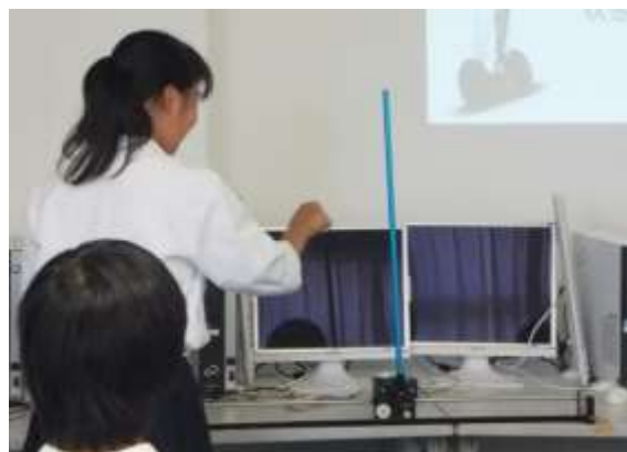
■倒立振り子ロボットの自動制御
