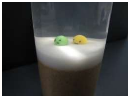
■ ペットボトル内での液状化の様子
