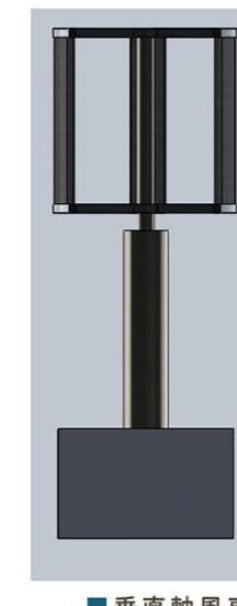
しかし、浮体式洋上風車において、垂直軸風車の重心の低さは大きなメリットとなり、今後、風車が超大型化される可能性を考えると垂直軸型は逆に有利になります。本年度は、垂直軸型風車が浮体の上に設置され洋上で波や潮流により動搖した場合の出力特性に関する研究と超大型の垂直軸型風車を3次元CADで設計することにより、風車の重心位置や総重量、構造的に大型化した垂直軸型風車の実現可能性について考察をおこないました。
