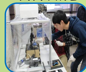
インプリントでマイクロギヤパターンの形成
