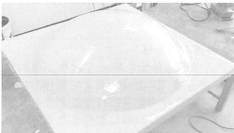
Fig. 5 発泡スチロール用の樹脂を表面に塗る
