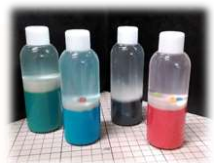
■ ペットボトル内での液状化実験
