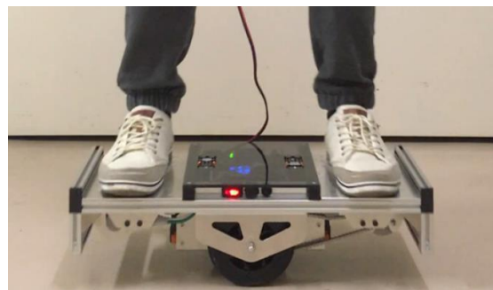
■ 二輪スケートボードの自動制御
