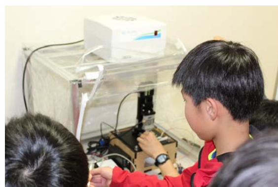
■ 超音波振動を利用した液滴室温ナノインプリント
