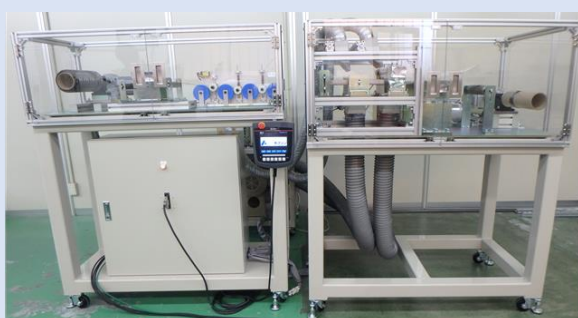
炭素繊維などを幅広く薄いテープ状に開織する装置 (福井県と共同特許を取得)
