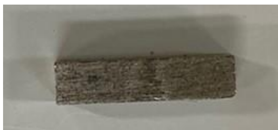
■ 摩擦磨耗試験後の砥石表面
