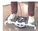
二輪スケートボードの自平衡制御
