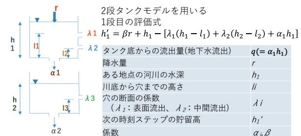
図13 解析に用いた2段タンクモデル
