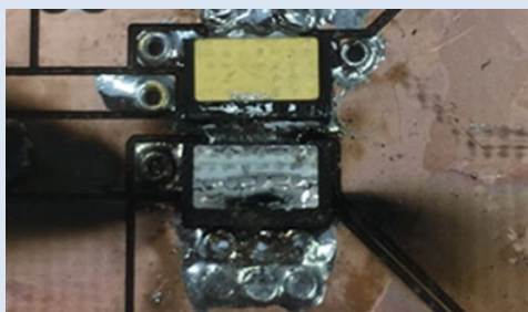
Fig. 2 GaN 誤点弧による熱暴走
