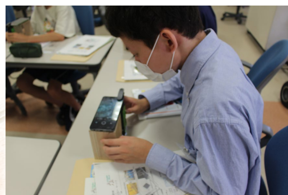
■デジタルスマホ顕微鏡で DLC パターンの計測
