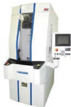
◀ 超高精度穴加工機 ホーニングマシン 加工対象物の内径を精密に 研磨する省エネ型工作機械
