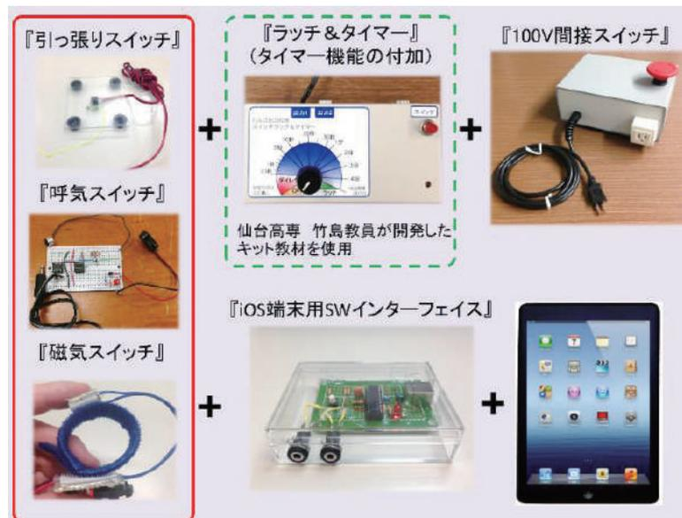
図 1 スイッチ教材と教材連携の例
