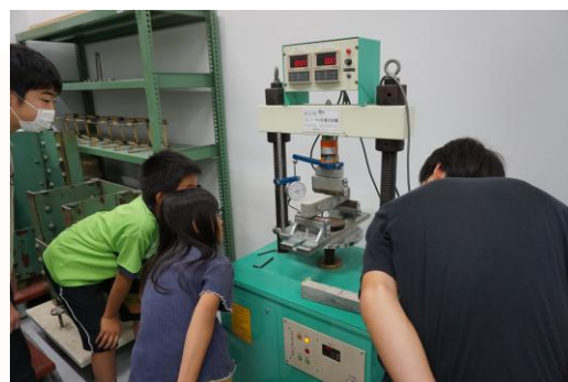
■ 鉄筋コンクリートはりの曲げ試験
