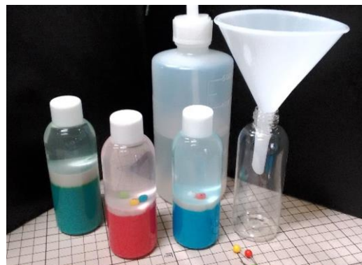
■ 作成したペットボトル液状化装置
